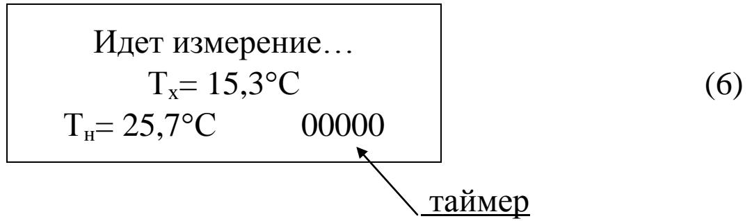
2.4.7 В дальнейшем управляя нагревателем и холодильником программное устройство прибора устанавливает на поверхностях образца заданные температуры  $T_h$  и  $T_x$ , и поддерживает их с точностью  $\pm 0,2^{\circ}\text{C}$  до тех пор, пока тепловой поток, проходящий через измеряемый образец, не стабилизируется.
